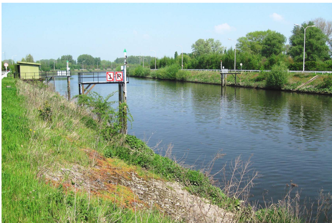
Langs de Dender te Dendermonde (Appels) is vlak voor de uitmonding in de Zeeschelde, een continue debietmeter opgesteld. Bij grote afvoer uit de Dender is er beduidende invloed (verhoging) op het laagwater van de Zeeschelde te Dendermonde.
