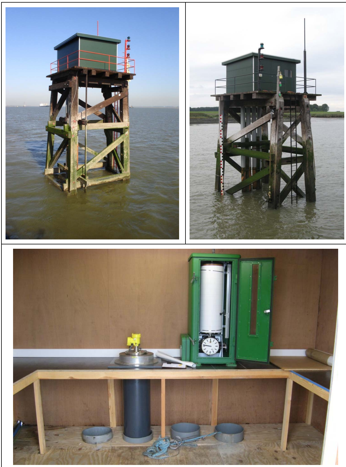
Bovenaan: de dukdalf van de meetpost Prosperpolder. De onderste foto toont links de eigenlijke radar-meetsonde en rechts de klassieke "papierene" Ott-Büsum-tijmeter. Ondertussen is nog meer apparatuur in de meethut geplaatst.
